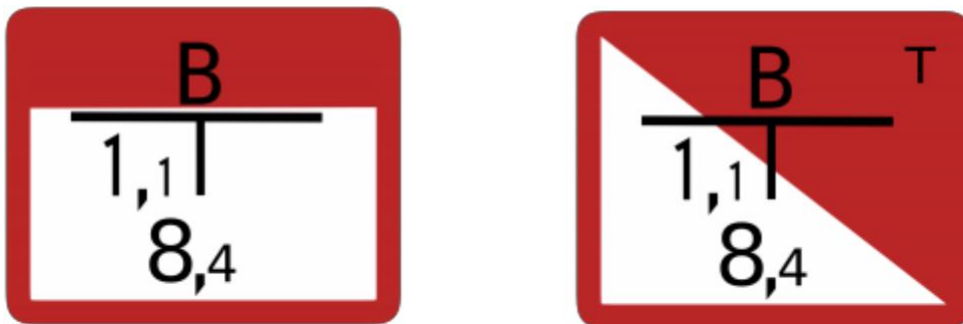
Abbildung 15: Beschilderung von Löschwasserbrunnen, links für Saugbetrieb, rechts mit Tiefpumpe (T)
