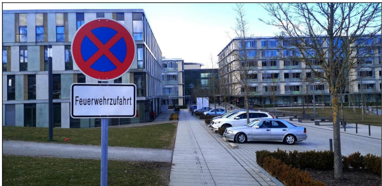
Abbildung 5: Beispiel einer befestigten Zufahrt für die Feuerwehr mit Beschilderung an der OSK Ravensburg
